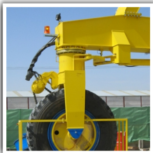
ROBUST STYRING, PROPORTIONEL MED OMDREJNINGSRADIUS
