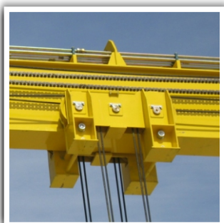
FORSKYDELIG LØBEVOGN MED LASTBEGRÆNSNING OG VÆGTSUMMERING
